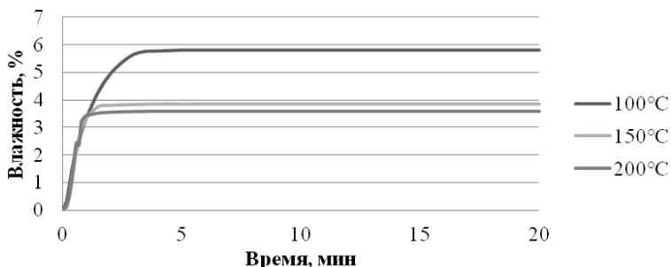
Рис. Влажность смеси при различных температурах сушки
