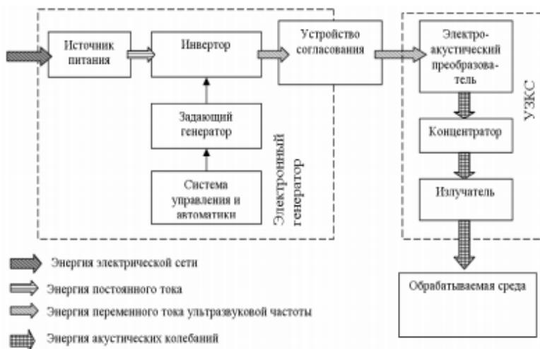
Рис. Структурная схема ультразвукового технологического аппарата
